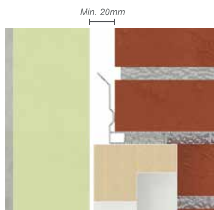
Muröppningsformens rygg är 20 mm djup, erforderligt utrymme måste därför finnas, till exempel genom en luftspalt eller inskärning i isolering.
