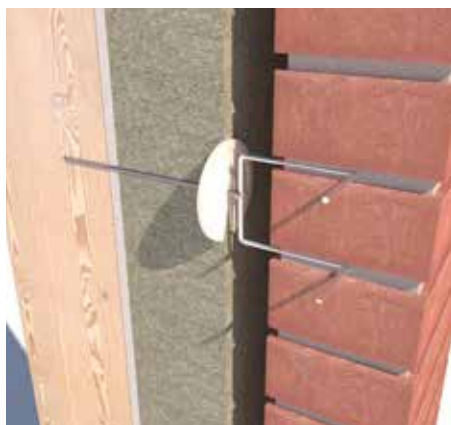
Figur 3.2.3 Kramla med isoleringsbricka.
